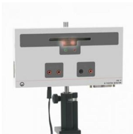
Appareil de mesure opto-électronique pour l'enregistrement des oscillations de balances de gravitation.
