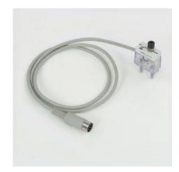
Adaptateur pour aimant de maintien avec déclencheur
