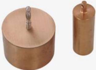
Pour les expériences sur le rail ( 337 130 ). Se composent d'une masse d'entraînement spéciale de force 1 N et d'une masse additionnelle pour que la masse totale à accélérer soit de 1 kg.
