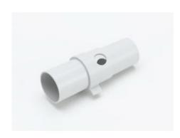
Pour la régulation de l'arrivée d'air et l'interruption sans secousses du mouvement du mobile sur le banc à coussin d'air ( 337 501 ) pour relever les états momentanés lors d'expériences sur les impulsions. Le clapet d'étranglement est positionné entre l'embout et le tuyau d'arrivée d'air. Muni d'une vanne et de raccords pour le tuyau.
