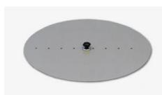
Permet de réaliser des mesures du moment d'inertie également pour des axes excentriques et de vérifier le théorème de Steiner.
