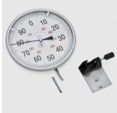
Pour mesurer les allongements. Le support permet la fixation sur le pyromètre à cadran (381341).
