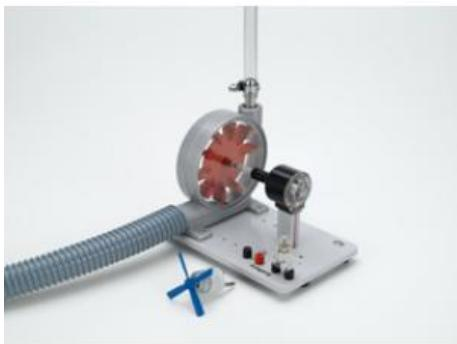
**Modèle centrale hydroélectrique (étude d'une turbine Pelton)**
