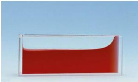
Pour mettre en évidence les forces de capillarité et déterminer la tension superficielle de liquides mouillants et non mouillants.
