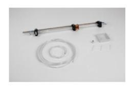
Permet de déduire l'équation d'état (transformation adiabatique), de déterminer le rapport c p /c V frottement intérieur des gaz ainsi que d'étudier la réponse en amplitude et en phase en cas de résonance. Se compose d'un tube en verre avec deux robinets à une voie, de deux pistons magnétiques, d'une bobine avec support, d'une tige à section hexagonale, de tuyaux en PVC et de raccords pour tuyaux.
