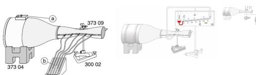
Pour l'étude de la pression statique à l'intérieur d'un tube à étranglement.
