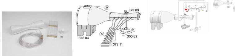
Pour l'étude de la pression statique à l'intérieur d'un tube à étranglement.
