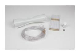
Pour l'étude de la pression statique à l'intérieur d'un tube à étranglement.
