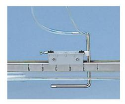
Sonde manométrique (Tube de pitot) complément nécessaire 37310 ou 524066 pour CASSY
