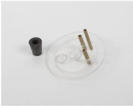
Composé d'un couvercle transparent avec possibilité de monter un filament chauffant (38422) ou un porte-échantillon (38423).
