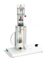
Moteur à air chaud (cycle de Stirling) à refroidissement
