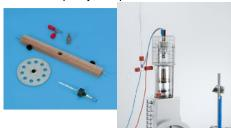
Pour la détermination quantitative du bilan des puissances, du freinage mécanique, de la mesure sans contact de la vitesse de rotation, de la mesure du débit et de la température du flux d'eau de refroidissement ainsi que pour la compensation électrique de la puissance frigorifique. À utiliser avec le moteur à air chard, 388 182.
