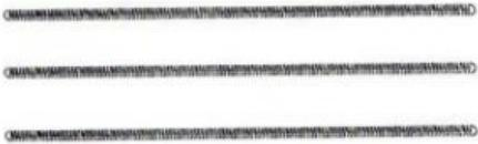
Pour les expériences de démonstration sur la propagation des ondes, par ex. pour la représentation d'ondes progressives et stationnaires ainsi que d'ondes à polarisation rectiligne et circulaire. Ressorts à raccorder l'un à l'autre.
