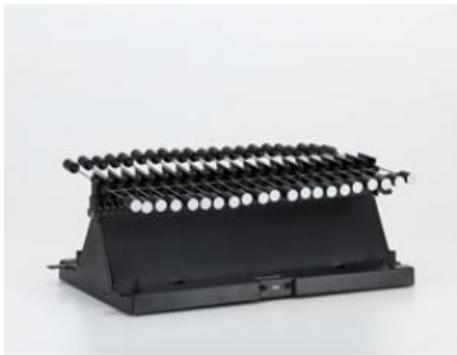
S'utilise avec le module de base 1 ( 40120 ) pour étudier la propagation des ondes dans des milieux de densité différente ; identique à ( 40120 ) si ce n'est que les pendules ont un moment d'inertie quatre fois moins grand.
