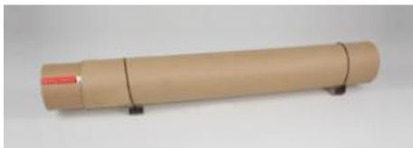
Dans un tube en carton à longueur variable (télescopique) avec échelle. Avec couvercle pour fermer le tube. En conjonction avec un haut-parleur (par exemple, 587 09, 587 08), les phénomènes de résonance peuvent être rendus acoustiquement audibles.
