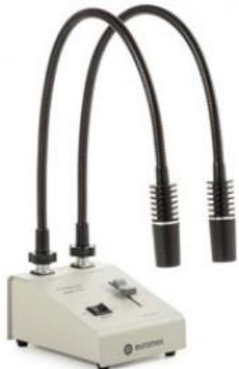
Source lumineuse compacte avec deux guides en col de cygne autonomes avec 2x 3 watts Power-LED (6500 K). La source lumineuse produit une lumière blanche et est graduable sans décalage de la température de couleur. Chaque guide LED à col de cygne est équipé d'une tête de focalisation à 3 lentilles et a une longueur de 56 cm. La source lumineuse a une durée de vie plus longue que les sources lumineuses halogènes ainsi qu'une faible consommation d'énergie.
