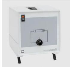
Pour l'alimentation des lampes spectrales ( 451011 -111), d'une lampe haute pression au mercure ( 45115 / 451 151 ) et de la lampe au cadmium ( 45112 ).
