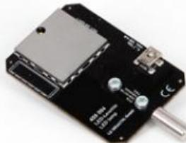
Lampe DEL pour des expériences d'étudiant sur l'optique de faisceau dans le Caisse de boîte à lumière (459093) et pour l'optique géométrique sur le rail métallique de précision (46082).
