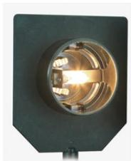
Lampe d'intensité lumineuse élevée pour toutes les expériences d'optique sur un banc d'optique.
