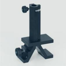
Cavalier pour banc d'optique à profil normalisé.
