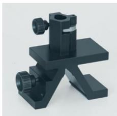
Cavalier pour banc d'optique à profil normalisé.
