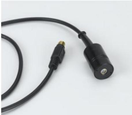
Photodiode InGaAs pour des mesures dans le proche infrarouge au-delà de la bande interdite du silicium. Généralement pour des longueurs d'onde de 1550 nm ou 1300 nm. Connecteur PS/2 pour l'amplificateur de signal (4743061).
