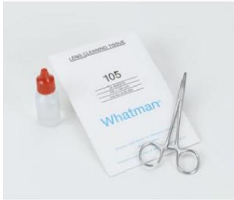
Kit de nettoyage spécial composants optiques laser, constitué de feuilles de papier non pelucheux, d'une pince moustique pour tenir le papier pendant le nettoyage et d'un flacon compte-gouttes pour le liquide de nettoyage (par ex. alcool, acétone).
