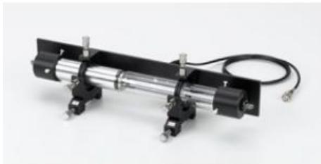
Tube laser à hélium-néon avec fenêtres de Brewster des deux côtés pour le montage d'un laser HeNe.
