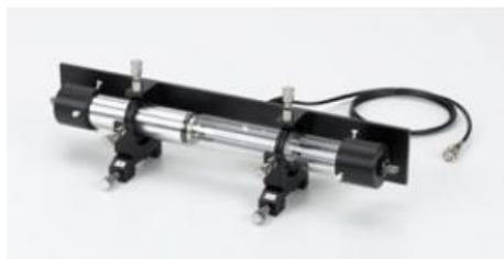
Tube laser à hélium-néon avec fenêtres de Brewster des deux côtés pour le montage d'un laser HeNe. Monté dans deux cavaliers ajustables sur les axes XY pour ajuster l'orientation du capillaire. Alimentation électrique assurée par un cable raccordé avec connecteur haute tension. Les raccords haute tension sont recouverts par des capuchons protecteurs collés.
