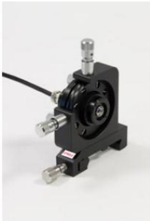
Laser à diode rouge à luminosité réglable. Le laser est décalé latéralement afin de générer avec le séparateur de faisceau 474187 deux faisceaux symétriques, par exemple pour une anémométrie laser Doppler. Dispositif d'ajustage X,Y - ?, f pour l'orientation du faisceau inclus.
