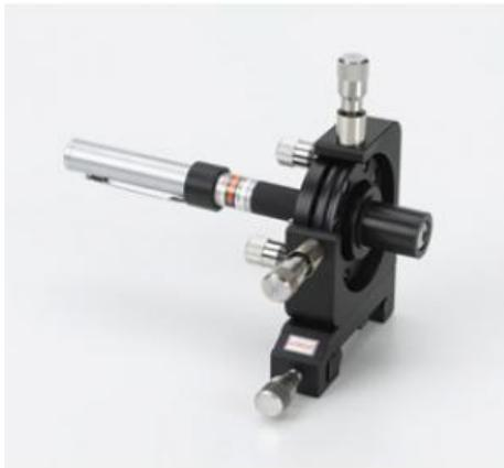
Pointeur laser vert dans support pour l'ajustage, par exemple du tube laser HeNe 474127 .
