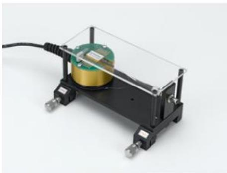
Le module contient un laser à diode intégré dans un boîtier papillon.
