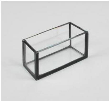
Pour la réalisation d'expériences d'optique avec les liquides telles que, par ex. sur la polarisation, la dispersion.
