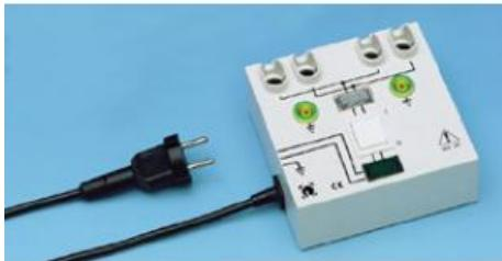
Pour brancher au réseau des montages ouverts réalisés en laboratoire à l'aide de câbles d'expérimentation de sécurité.
