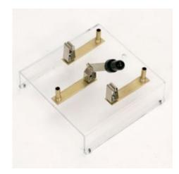
Commutateur inverseur à tige monté sur un socle
