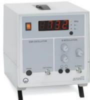
Alimentation en énergie pour l'émetteur HF de l'appareil de base RSE ( 514 55 ) et la paire de bobines de Helmholtz ( 555 604 ) pour les expériences sur la résonance de spin électronique.
