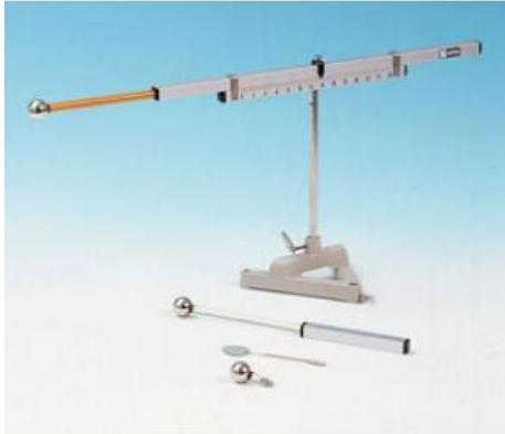
Pour la mesure des forces entre des sphères électrisées en fonction de la charge et de l'écartement (loi de Coulomb) ainsi que pour l'étude quantitative du rapport entre les forces d'un champ électrique et des forces mécaniques ; permet aussi de déduire la constante d'influence.
