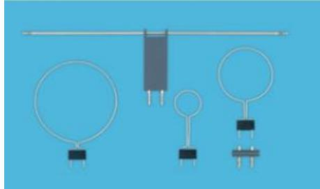
Pour mesurer l'induction magnétique sur des conducteurs rectilignes et annulaires parcourus par un courant (loi de Biot et Savart).
