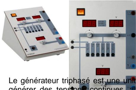
Le générateur triphasé est une unité d'alimentation de laboratoire disposée dans un boîtier de table pour générer des tensions continues, alternatives et triphasées pour l'alimentation des machines d'entraînement électriques (charges inductives-résistives) basées sur des onduleurs..
