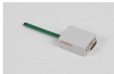
Pour la mesure de la densité du flux magnétique de petits champs en direction axiale avec CASSY ( 524013 , 524006 , 524005W , 524018 ) ou l'instrument de mesure universel Physique ( 531835 ). La sonde sert par exemple à mesurer la valeur et la direction du champ magnétique terrestre (40 ... 60 $\mu\text{T}$ ) ou à mesurer le champ magnétique d'un conducteur traversé par un courant continu ou alternatif (Biot et Savart).
