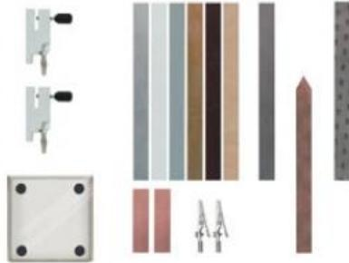
Pour la réalisation de circuits pour l'étude de la conduction électrique dans les solides et les liquides. Complément pour 539070 . Thèmes : - Le courant électrique dans les solides et les liquides - Action chimique du courant électrique La cuve s'utilise sur le tableau magnétique ( 301301 ).
