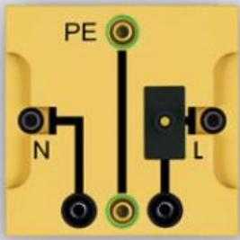
Composant avec 6 douilles de sécurité pour le raccordement des conducteurs extérieur, neutre et de protection. Coupe-circuit thermique dans le conducteur extérieur. S'utilise sur le tableau magnétique ( 301301 ).
