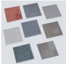
Utilisées avec le détecteur d'énergie de rayonnement X ( 559 938 ), le Sensor-CASSY ( 524 013 ) et l'adaptateur AMC ( 524 058 ), les cibles permettent de relever les spectres de fluorescence X de différents éléments dans l'appareil à rayons X ( 559 801 ).
