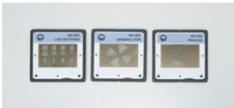
3 modèles d'essai (traits, mire de siemens, diaphragme à trou) pour déterminer le pouvoir de résolution du module de tomodensitométrie (554 821), ou du capteur pour radiographie ( 554 828 ) ainsi que la taille du point focal du tube à rayons X.
