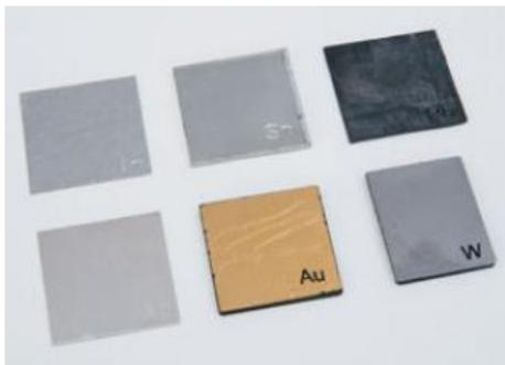
Utilisées avec le détecteur d'énergie de rayonnement X ( 559 938 ), le Sensor-CASSY ( 524 013 ) et l'adaptateur AMC ( 524 058 ), les cibles permettent de relever les spectres de fluorescence X de différents éléments dans l'appareil à rayons X ( 559 801 ).
