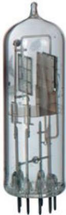
Pour mettre en évidence l'émission d'énergie discontinue d'électrons libres par collision avec des atomes de mercure, et pour en déterminer l'énergie d'excitation.
