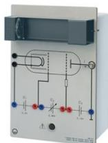
Support pour tube de Franck-Hertz au néon monté sur une plaque d'expérimentation qui peut être utilisé seul ou dans un cadre d'expérimentation et de démonstration ( 301300 ).
