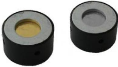
Feuille d'or et feuille d'aluminium pour expériences sur les pertes d'énergie des rayons alpha dans la matière.
