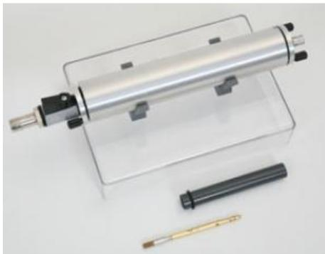
Pour mesurer les énergies des rayons alpha dans le vide. Tube métallique pouvant être mis sous vide, bride avec connecteur BNC pour détecteur ( 559 921 ou de 559 56 ), bride avec support de préparation pour fiche de 4mm et raccord pour pompe à vide. À l'aide des adaptateurs fournis, il est possible d'utiliser les préparations suivantes avec une fiche de 4mm, un filetage M5 ou un diamètre de 12mm: 559 436 , 559 821 , 559825 , 559 835 , 559 845 .
