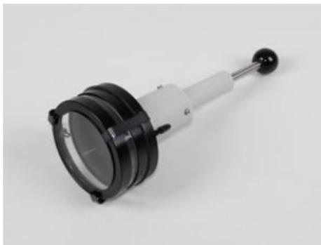
Pour visualiser les trajectoires de particules  $\alpha$  ; brève durée de condensation du mélange alcool/vapeur d'eau dont la sursaturation par détente adiabatique est obtenue au moyen d'une pompe à air manuelle ; couvercle avec fenêtres en verre acrylique pour l'observation et le passage de la lumière ; douilles de raccordement pour tension de drainage servant à désioniser et support pour préparation de radium ( 559596 ).
