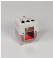
Bobine basse tension. En cas d'utilisation comme bobine secondaire, peut fournir une basse ou une haute tension. Ne convient donc pas pour les travaux pratiques.
