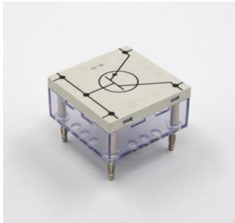
Étages préliminaires et interrupteurs pour faibles signaux.
