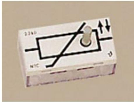
Thermistance à coefficient de température négative avec sonde saillante.
