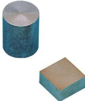
**Jeu de 2 corps pesants pour TP masse volumique et capacité calorifique de différents matériaux**
